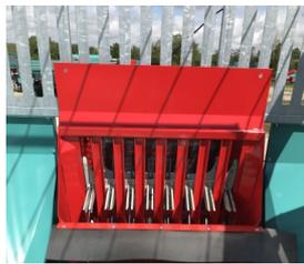
L'élévateur de 950 mm pour les Palès et 1300 mm pour les Érès est centré sur la largeur de la caisse, lors du départ de la machine le poids est réparti et donne une meilleure stabilité à la machine. Entraînement hydraulique du convoyeur par motoréducteur hydraulique à bain d'huile (sur arbre haut) et régulateur de débit.
