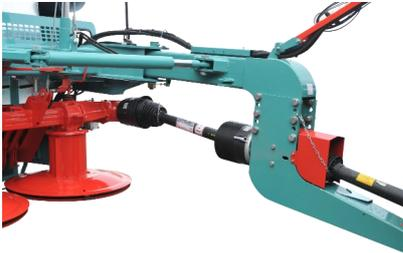
La gamme Palès possède une flèche basse pour un meilleur report de charge ainsi qu'un palier central pour préserver les cardans. Elle est réglable en hauteur (sauf sur les modèles 200,300 et 300 XL) pour s'adapter à tout type de terrain. Le vérin de dépliage est prit en extérieur du châssis pour éviter le phénomène de piquage et augmenter par effet le bras de levier lors du pliage/dépliage. Les vérins sont montés sur rotules.
