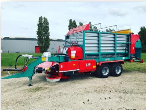
Les Palès 200 & 300 sont les autochargeuses à coupe rotative les plus compactes de la gamme Palès. D'un volume de 18 & 24 m<sup>3</sup>, elles possèdent 2 hérissons démêleurs ainsi qu'un tapis de déchargement.
