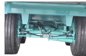
Balancier suiveur avec blocage hydraulique.
