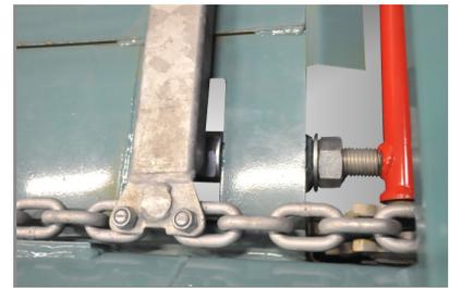
Le tapis est à la largeur de la caisse pour ne pas perdre de matière (largeur 1.45 m). Le montage des noix et décrotoirs permet de guider la chaîne et d'éviter le déraillement.
