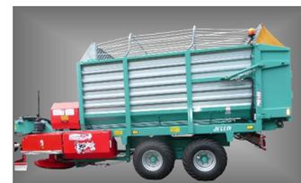
Porte arrière à ouverture hydraulique (déchargement arrière) supprime les hérissons démêleurs et le tapis.
