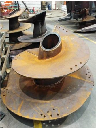
Les vis verticales coniques se croisent offrant un gain de puissance et une rapidité de mélange. La coupe est plus rapide et homogène grâce aux pieds de vis larges. Le mélange est optimal, idéal pour de petites quantités et la vidange intégrale de la cuve. Les couteaux sont en carbure de tungstène ce qui augmentent leur longévité. A la base de chaque vis, des racleurs réglables permettent un réglage optimum et une facilité d'entretien.
