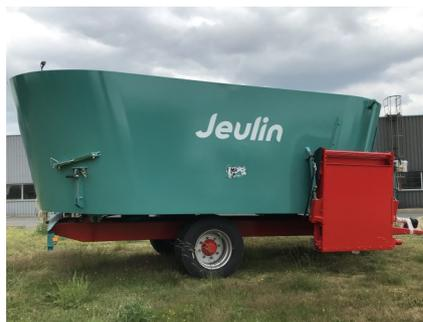
La mélangeuse à vis verticale (s) Activa F2 possède un châssis indépendant (pesage en 4 points). Les vis de ce modèle se croisent permettant un mélange homogène et une distribution optimale.
