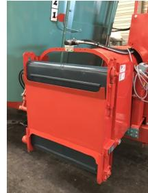
Déport hydraulique du tapis 0.50 m à droite ou à gauche ou déport 0.25 m à droite et à gauche.
