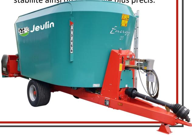
Cette machine est idéale pour une exploitation de taille moyenne, son châssis est intégré à la cuve ce qui en fait une machine étroite et surbaissée. Elle nécessite peu de puissance et se montre très efficace pour les petits mélanges. Ses vis se croisent ce qui permet un mélange homogène même pour de faibles quantités ainsi que la vidange totale de la cuve.
