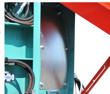
L'enveloppe de turbine d'une largeur de 320 mm est en acier anti-abrasion (dureté Brinell hb acier 120 kg). Trappe de turbine pour une intervention technique facile.
