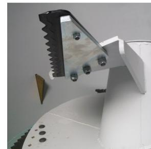
2 angles d'attaque sur les couteaux n° 3 et 4 en partant du bas, ce qui permet de mieux régler la distribution.
