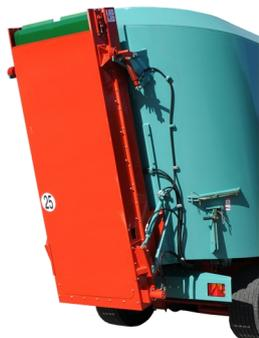
Tapis de déchargement centrale AR, relevage hydraulique.
