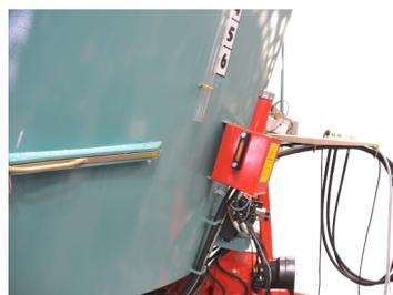
L'entraînement des vis est assuré par un réducteur renvoi d'angle à bain d'huile, avec un réservoir en charge de 4 litres offrant un graissage intégral du boîtier. Le boîtier d'entraînement est fixé à mi-hauteur de la vis pour un équilibre parfait et une limitation des contraintes latérales lors des mélanges. Ce montage améliore ainsi la durée de vie de l'ensemble.
