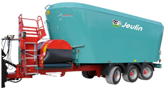
Les modèles de mélangeuses à vis verticales Activa et Boramel sont déclinées en version **3 vis** de 30 à 45 m<sup>3</sup>. A partir de cette capacité, ces mélangeuses sont équipées d'un tridem. Sur toutes ces machines, le pesage sera réalisé sur 6 points.
