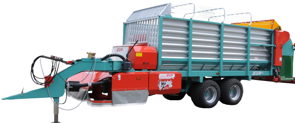
Déchargement latéral à D ou à G tapis porte (sans démêleur).
