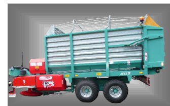
Porte arrière à ouverture hydraulique (déchargement arrière) supprime les hérissons démêleurs et le tapis.
