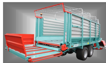
Déchargement latéral à D ou à G tapis porte (sans démêleur).
