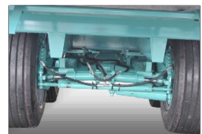
Balancier suiveur avec blocage hydraulique.
