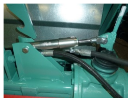
Enclenchement hydraulique de la coupe par vérin.
