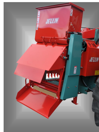
Trémie de distribution capacité 150 litres.
