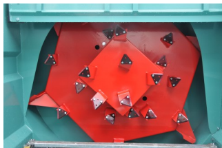
Sections sur turbine.
