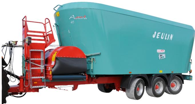
Les modèles de mélangeuses à vis verticales Activa et Boramel sont déclinées en version **3 vis** de 30 à 45 m<sup>3</sup>. A partir de cette capacité, ces mélangeuses sont équipées d'un tridem. Sur toutes ces machines, le pesage sera réalisé sur 6 points.
