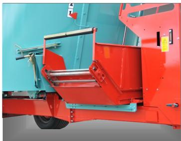
Tapis incliné largeur 800 mm pour auge 0,60 m à 1,10 m avec déport hydraulique côté incliné de 0,50 m.
