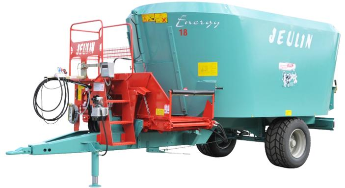
Cette machine est idéale pour une exploitation de taille moyenne, son châssis est intégré à la cuve ce qui en fait une machine étroite et surbaissée. Elle nécessite peu de puissance et se montre très efficace pour les petits mélanges. Ses vis se croisent ce qui permet un mélange homogène même pour de faibles quantités ainsi que la vidange totale de la cuve.
