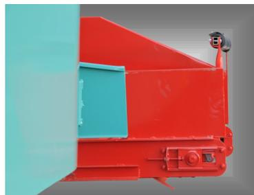
Déport hydraulique du tapis 0.50 m à droite ou à gauche ou déport 0.25 m à droite et à gauche
