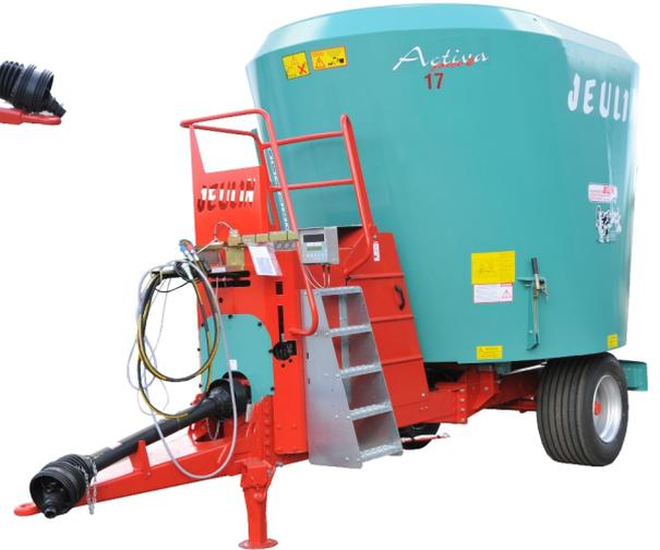
La mélangeuse à vis verticale (s) Activa F2 possède un châssis indépendant (pesage en 4 points). Les vis de ce modèle se croisent permettant un mélange homogène et une distribution optimale.
