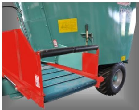
Tapis bilatéral PVC à plat uniquement largeur 800 mm en remplacement des chaînes
