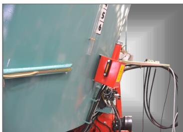
L'entraînement des vis est assuré par un réducteur renvoi d'angle à bain d'huile, avec un réservoir en charge de 4 litres offrant un graissage intégral du boîtier. Le boîtier d'entraînement est fixé à mi-hauteur de la vis pour un équilibre parfait et une limitation des contraintes latérales lors des mélanges. Ce montage améliore ainsi la durée de vie de l'ensemble.
