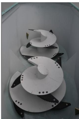
Les vis verticales coniques se croisent offrant un gain de puissance et une rapidité de mélange. La coupe est plus rapide et homogène grâce aux pieds de vis larges. Le mélange est optimal, idéal pour de petites quantités et la vidange intégrale de la cuve. Les couteaux sont en carbure de tungstène ce qui augmente leur longévité. A la base de chaque vis, des racleurs réglables permettent un réglage optimum et une facilité d'entretien.
