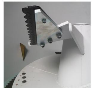
2 angles d'attaque sur les couteaux n° 3 et 4 en partant du bas, ce qui permet de mieux régler la distribution.
