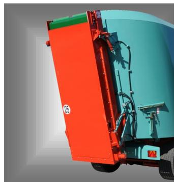
Tapis de déchargement centrale AR, relevage hydraulique.
