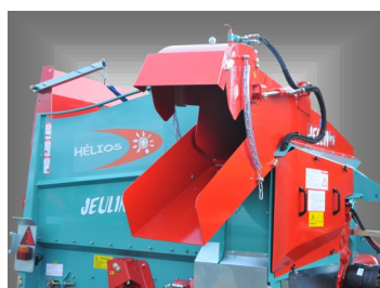
Goulotte de distribution-paillage orientable AV et AR 30°.
