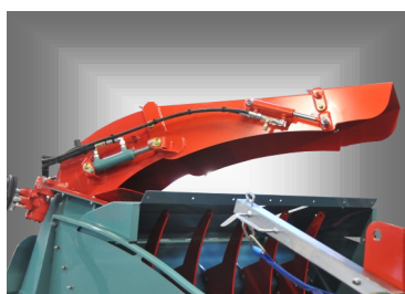
Vérin hydraulique sur casquette de goulotte.
