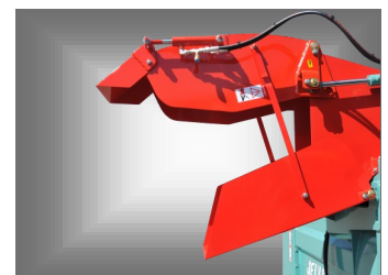
Vérin hydraulique sur casquette de goulotte.
