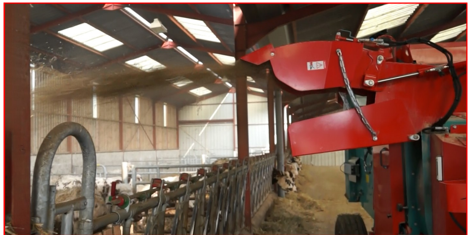
Repliage hydraulique de la goulotte de mélange sur la gauche sur Ouragan.
