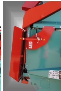
Réglage hydraulique du toboggan.
