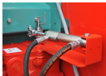
Changement de vitesse électrique sur boîtier de turbine.
