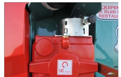
Boîtier 2 vitesses à commande manuelle (distribution 270 trs/mn - paillage 540 trs/mn).
