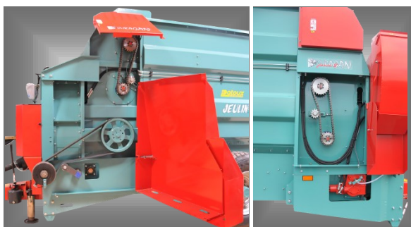
Entraînement par courroie multi-brins et chaîne double. Tendeur automatique.
