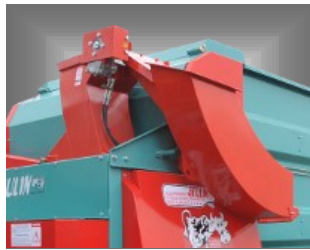
Repliage hydraulique de la goulotte de mélange sur la gauche sur Ouragan.
