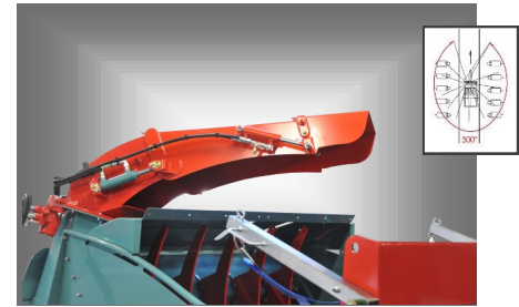
Mono-goulotte avec kit hydraulique de distribution - paillage orientable à 300°.
