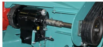
L'embrayage\* multi-disques à bain d'huile proposé exclusivement par Jeulin permet de limiter les contraintes lors de la mise en route de la machine. Il permet un certain confort de travail et augmente la longévité des différents organes.
