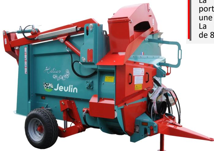
La Hélios est une désileuse pailleuse distributrice portée ou semi-portée d'une capacité de 3,80 m<sup>3</sup>. C'est une machine compacte possédant un démêleur. La turbine d'un diamètre de 1650mm est munie de 8 pales démontables.
