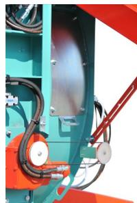
L'enveloppe de turbine d'une largeur de 320 mm est en acier anti-abrasion (dureté Brinell hb acier 120 kg). Trappe de turbine pour intervention technique facile.
