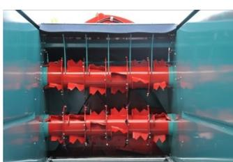
Chaque hérisson démêleur a un diamètre de 590 mm avec un arbre transversal de diamètre 45 mm. Il est ainsi plus agressif au démêlage du produit et plus résistant.
