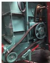
Des modèles Hélios à Sirius, en version démêleur mécanique, le J Drive est un embrayage par courroie débrayable. Il permet de dissocier la rotation du démêleur de celle de la turbine.
