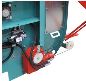
Entraînement du tapis par moto-réducteur électrique à bain d'huile, marche avant et arrière avec régulateur de vitesse électrique. Témoin de sens de rotation du tapis visible de la cabine du tracteur.
