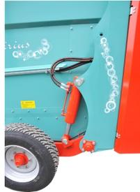
Le désilage est réalisé par une griffe arrondie ce qui permet un meilleur remplissage et diminue la pression sur le ou les démêleurs. Les 2 vérins de griffe et les 2 vérins de bras sont pris en chape afin d'être protégés. Une tôle d'étanchéité sur dents de griffe escamotable par ressort limite les contraintes de la matière ce qui augmente sa force. L'essieu hydraulique actionné par 2 vérins également pris en chape offre un chargement optimal de la machine.
