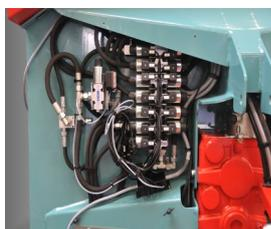
Distributeur à commande électrique de toutes les fonctions avec boîtier mobile en cabine. La double commande électrique arrière gauche commande le tapis et la porte sans avoir à retourner dans la cabine du tracteur (de série sur les Sirius avec en plus commande de l'essieu). Une électrovanne = 1 fonction, ce qui permet d'actionner chaque fonctions indépendamment.
