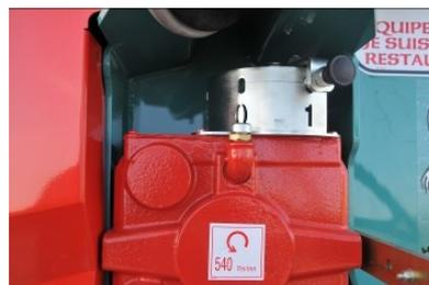
Boîtier 2 vitesses à commande manuelle (distribution 270 trs/mn - paillage 540 trs/mn).
