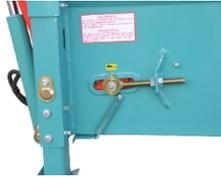
Le tendeur de tapis est placé à l'extérieur de la caisse. Le double fond d'étanchéité dispose d'une trappe arrière de nettoyage ce qui facilite la récupération de corps étrangers.
