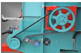
Des modèles Hélios à Ouragan, l'entraînement mécanique par courroie multi-brins et tendeur automatique (exclusivité Jeulin) apporte fiabilité et souplesse de fonctionnement.
