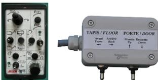
Distributeur à commande électrique de toutes les fonctions avec boîtier mobile en cabine. La double commande électrique arrière gauche commande le tapis et la porte sans avoir à retourner dans la cabine du tracteur (de série sur les Sirius avec en plus commande de l'essieu). Une électrovanne = 1 fonction, ce qui permet d'actionner chaque fonction indépendamment.
