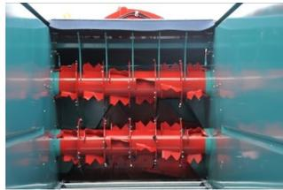
Chaque hérissone démêleur a un diamètre de 590 mm avec un arbre transversal de diamètre 45 mm. Il est ainsi plus agressif au démêlage du produit et plus résistant. Chacun est équipé de 15 grandes sections pré-disposées pour enrubanné avec caisson à 2 reteneurs. Ce montage permet de passer tous types de produits.
