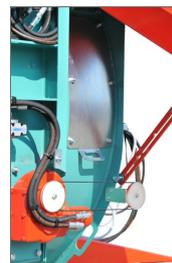
L'enveloppe de turbine d'une largeur de 320 mm est en acier anti-abrasion (dureté Brinell hb acier 120 kg).
