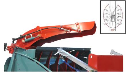
Mono-goulotte avec kit hydraulique de distribution - paillage orientable à 300°.
