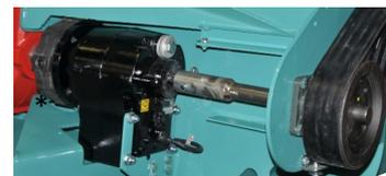
L'embrayage\* multi-disques à bain d'huile proposé exclusivement par Jeulin permet de limiter les contraintes lors de la mise en route de la machine. Il permet un certain confort de travail et augmente la longévité des différents organes.
