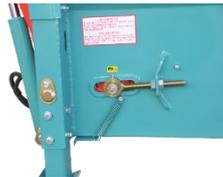
Le tendeur de tapis est placé à l'extérieur de la caisse. Le double fond d'étanchéité dispose d'une trappe arrière de nettoyage ce qui facilite la récupération de corps étrangers.
