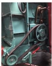
Des modèles Hélios à sirius, le J Drive est un embrayage par courroie débrayable. Il permet de dissocier la rotation du démêleur de celle de la turbine.
