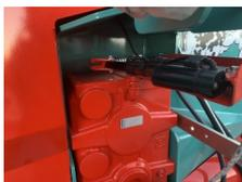
Changement de vitesse électrique sur boîtier de turbine.
