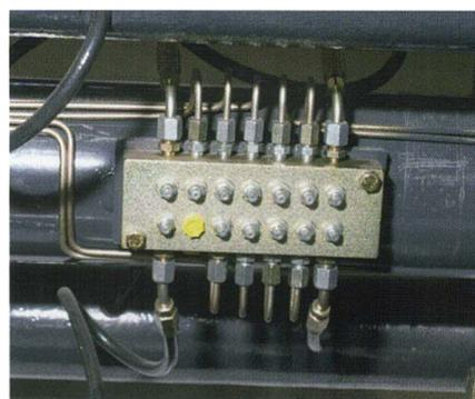
Le graissage centralisé permet un entretien simple, rapide et sans effort.
