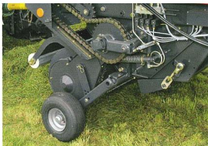
Pick-up débrayable ; à chaque remontée total du pick-up, l'entraînement de celui-ci se coupe.
