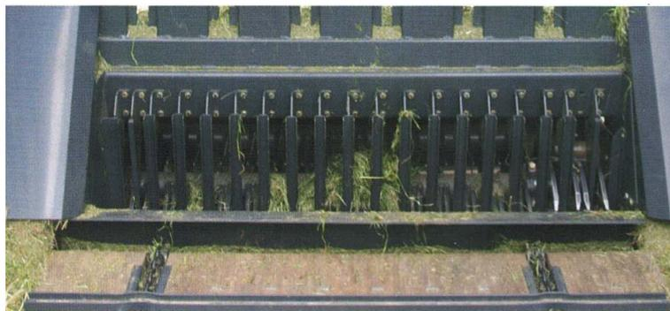
Parois intérieures lisses pour optimiser le chargement - convoyeur à chaînes et barrettes - plancher bois
