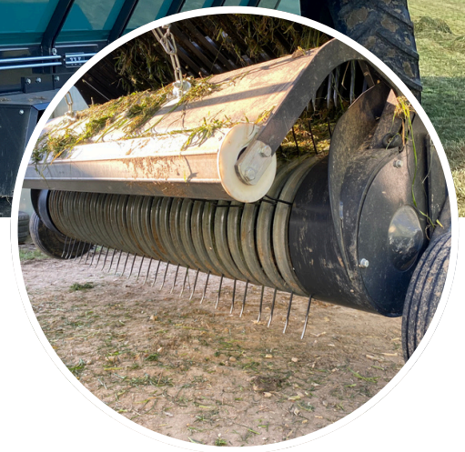
PICK-UP 5 RANGÉES DE DENTS AVEC ROULEAU RÉPARTITEUR
