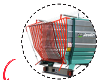
DÉCHARGEMENT ARRIÈRE AVEC PORTE À OUVERTURE MANUELLE
