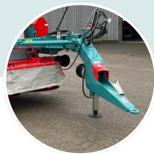
FLÈCHE D'ATTELAGE BASSE AVEC DÉPORT HYDRAULIQUE
