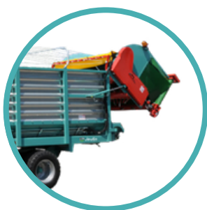
DÉCHARGEMENT ARRIÈRE À OUVERTURE HYDRAULIQUE TOTALE
