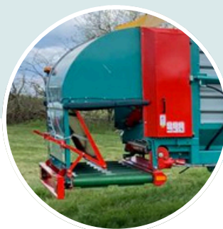
TAPIS PVC DE DÉCHARGEMENT ARRIÈRE BILATÉRAL
