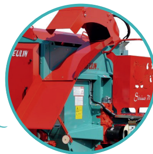
Mono-goulotte de distribution-paillage fixe actionnée par un vérin avec toboggan de distribution manuel .
