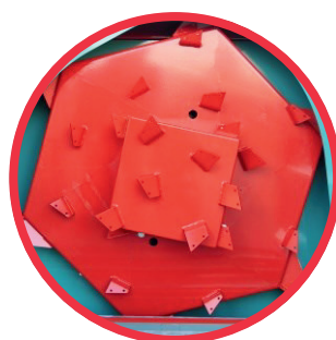
TURBINE AVEC CÔNE
