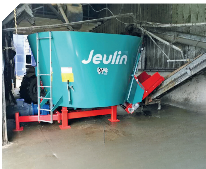
TAPIS DE DÉCHARGEMENT EN HAUTEUR SUR INSTALLATION DE DISTRIBUTION EXISTANTE
