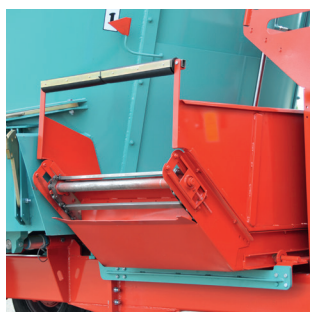
TAPIS INCLINÉ LARGEUR 800 MM POUR AUGES 0.60 M À 1.10 M AVEC DÉPORT HYDRAULIQUE CÔTÉ INCLINÉ DE 0.50 M
