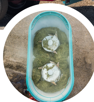
VUE AÉRIENNE DE LA CUVE DOUBLE VIS
