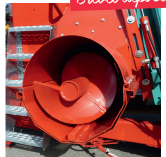
VIS DE DÉCHARGEMENT DISTRIBUE DE MANIÈRE RÉGULIÈRE (TAPIS D'ALIMENTATION NÉCESSAIRE)
