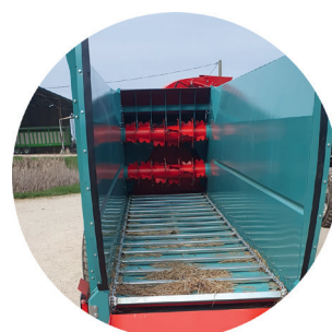
CAISSE ÉVASÉE FACILITANT LE CHARGEMENT PAR LE DESSUS
