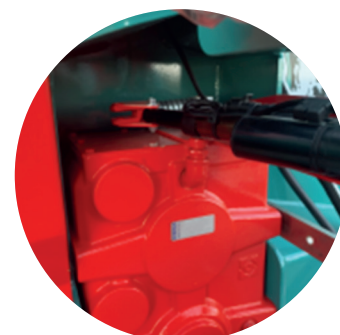
CHANGEMENT DE VITESSE ÉLECTRIQUE SUR BOÎTIER DE TURBINE
