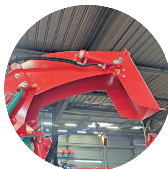
VÉRIN HYDRAULIQUE SUR CASQUETTE DE GOULOTTE
