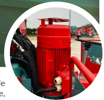
MOTEUR 2 ÉLECTRIQUE 22 KW/H
