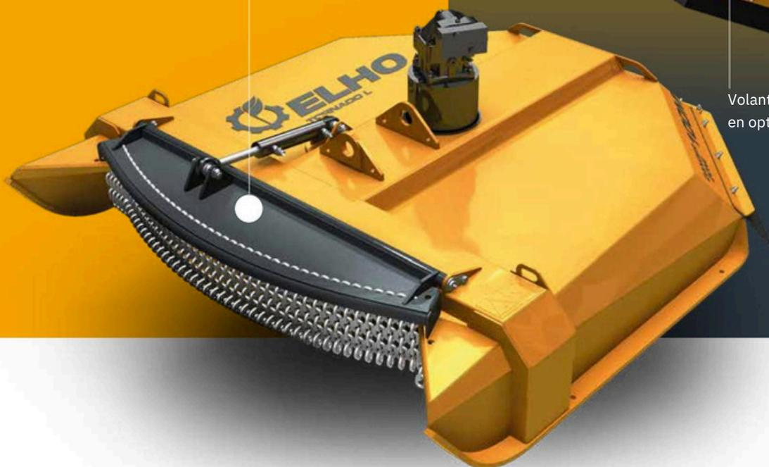
Le Tornado L est une tête de coupe à deux chaînes, adaptée aux engins à flèche. Il est conçue pour être utilisé avec des excavatrices, des chargeuses forestières et d'autres machines disposant d'une puissance hydraulique suffisante. Sa structure légère et robuste en acier Hardox garantit d'excellentes performances.
