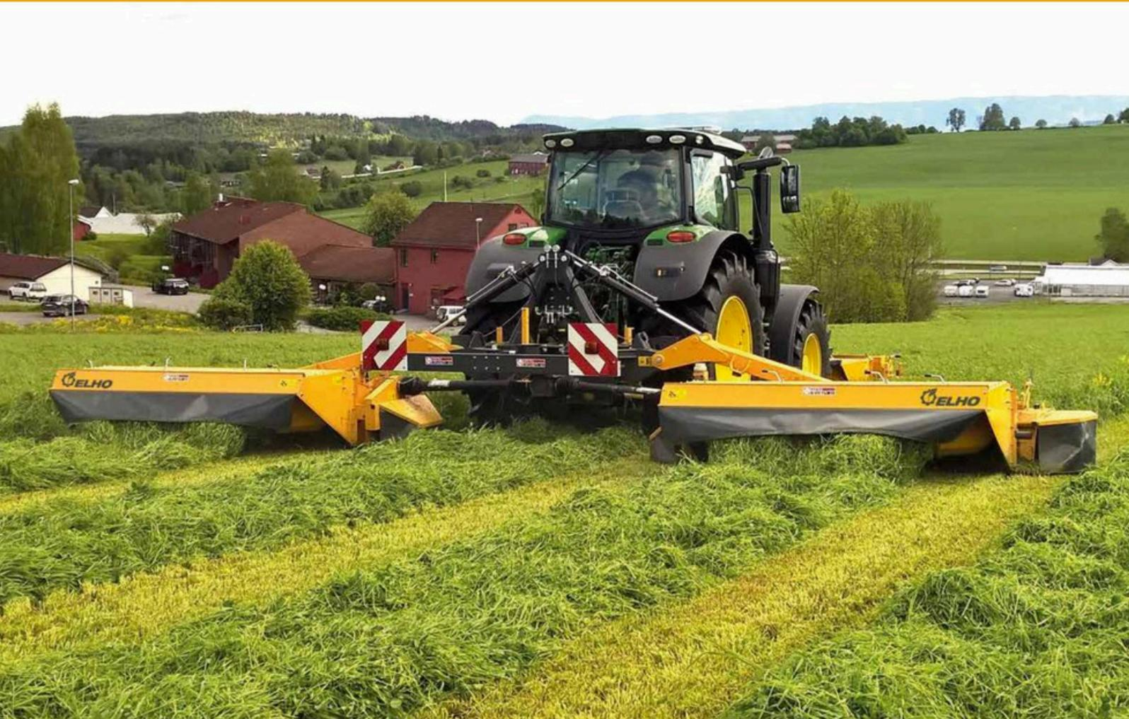
Les faucheuses-conditionneuses papillon ELHO constituent une combinaison efficace pour les grandes exploitations et les entreprises de travaux agricoles. Grâce à la combinaison d'une faucheuse-conditionneuse frontale et d'une faucheuse-conditionneuse papillon double, il est possible de récolter jusqu'à 15 hectares de fourrage par heure. Le fourrage peut être réparti en andains multiples ou groupé en un seul grand andain sur toute la largeur de travail.
