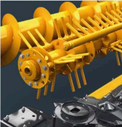
Les doigts forgés et arrondis des faucheuses-conditionneuses ELHO éliminent la cire superficielle des plantes fourragères sans les couper ni les replier. Les plantes fourragères conditionnées sèchent alors rapidement et l'andain est aéré grâce à leur longueur.
