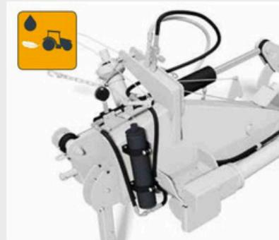
HydroBalance est une caractéristique clé des conditionneuses-faucheuses ELHO. Même si la faucheuse pèse des tonnes, HydroBalance utilise un vérin et un accumulateur de gaz pour alléger la majeure partie du poids de la machine supporté par le tracteur.
