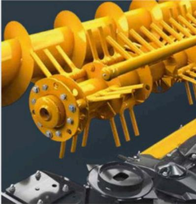
Les doigts forgés et arrondis des faucheuses-conditionneuses ELHO éliminent la cire superficielle des plantes fourragères sans les couper ni les replier. Les plantes fourragères conditionnées sèchent alors rapidement et l'andain est aéré grâce à leur longueur. Une contre-barre permet d'ajuster la puissance de conditionnement selon le résultat souhaité, mais elle peut également être désactivée pour la récolte de cultures fourragères plus sensibles.
