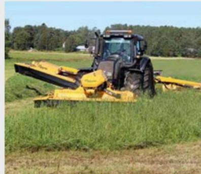
Les faucheuses-conditionneuses papillon se manipulent en regardant directement la machine, ce qui préserve le dos et la nuque. La Duett offre une ergonomie optimale grâce à sa marche arrière grâce au système de marche arrière du tracteur, offrant une vue dégagée sur les deux unités de coupe de 3,7 mètres par la lunette arrière.
