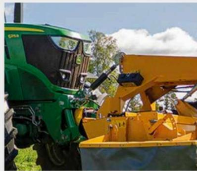
Le troisième point HydroBalance remplace le troisième point standard, augmentant la suspension de la faucheuse-conditionneuse frontale et offrant une hauteur de levage accrue. Ainsi, les faucheuses-conditionneuses frontales peuvent être relevées de plusieurs dizaines de centimètres, évitant ainsi tout contact avec les andains hauts en bout de champ, même avec le groupeur d'andains SideFlow.
