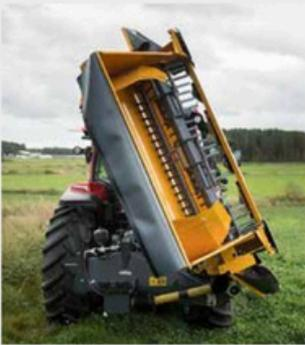
Les faucheuses-conditionneuses latérales sont surélevées au-dessus de l'axe central du tracteur pendant le transport, de sorte que le centre d'équilibre est aussi proche que possible de l'axe central et que la combinaison est stable pendant le transport. Lorsqu'elles sont entièrement relevées, les faucheuses-conditionneuses latérales sont également étroites et ne s'étendent pas au-delà des côtés du tracteur.
