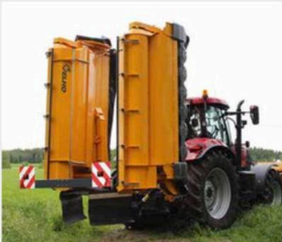
Toutes les faucheuses-conditionneuses papillon ELHO se replient rapidement et facilement pour un transport très étroit. Sur le modèle Duett, les deux ailes se replient verticalement vers le haut, et la largeur de la combinaison ne dépasse généralement pas celle du tracteur, selon les pneus.
