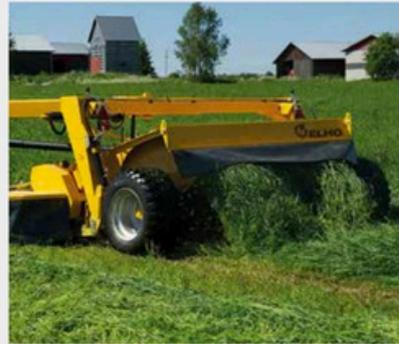
La barre d'attelage est dotée d'un système de choc à ressort à lame qui absorbe les chocs. Ce ressort protège également le renvoi d'angle. Le vérin de pivotement de la flèche est doté d'un amortisseur d'extrémité, ce qui assure un réglage en douceur de la flèche dans les deux positions extrêmes. Les vibrations et le bruit des faucheuses-conditionneuses traînées sont moins ressentis
