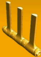
ELHO estime que les plantes fourragères conditionnées sèchent mieux en frottant la cire de surface plutôt qu'en la coupant. C'est pourquoi nos rotors de conditionnement sont dotés de doigts droits et arrondis et d'une contre-barre réglable à ressort.
