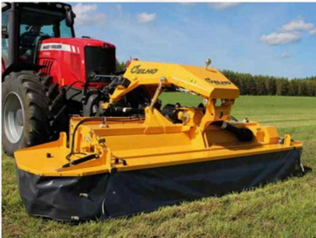
La NM 3700 F est la faucheuse-conditionneuse frontale monopoutre la plus large au monde. Avec une largeur de coupe de 3,7 mètres, ce modèle est extrêmement productif. Le conditionneur est également très efficace à grande vitesse et dans les zones de végétation dense.
