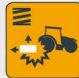
Les modèles VC sont dotés d'une protection mécanique contre les chocs. Ce système à ressort s'active automatiquement en cas d'impact avec un obstacle et permet à la faucheuse-conditionneuse de se relever et de reculer. La faucheuse-conditionneuse revient alors immédiatement et automatiquement en position de travail.
