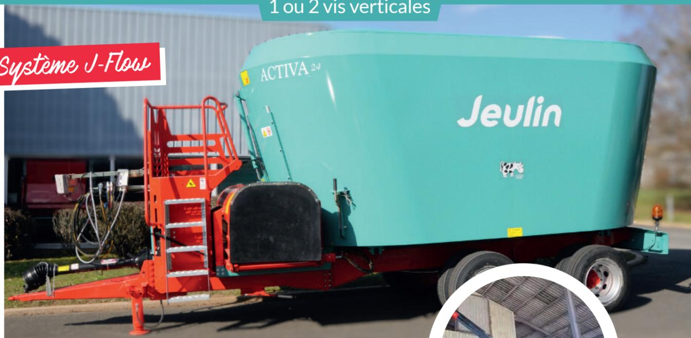
Cette mélangeuse possède un châssis indépendant permettant une meilleure précision de pesage. Elle assure un mélange homogène et une distribution optimale grâce aux vis de mélange qui, sur les modèles 2 vis, se croisent selon le système J-FLOW offrant une grande efficacité.
