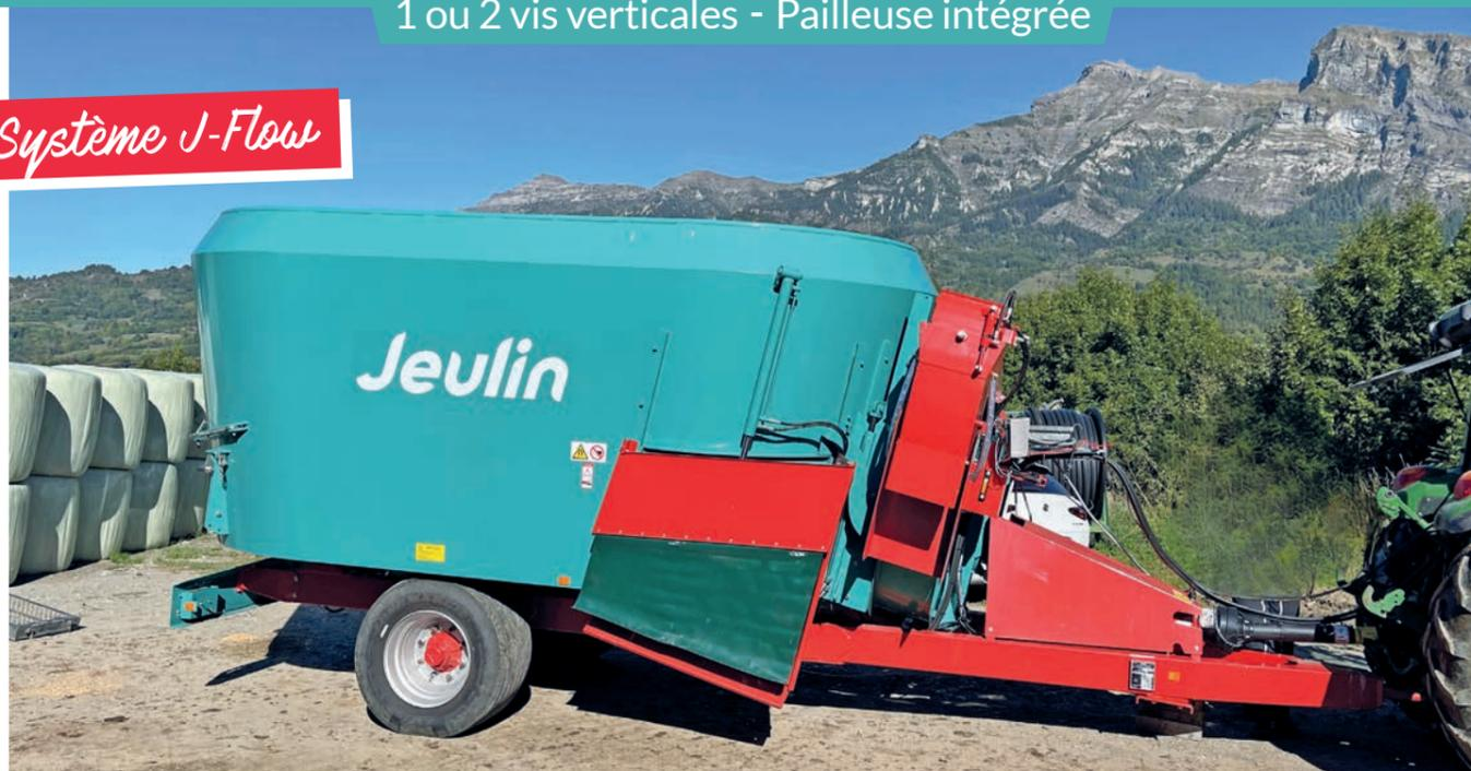
Cette mélangeuse est équipée d'un système de paillage intégré, ce qui en fait une machine complète qui, selon les équipements complémentaires choisis, s'adapte à de nombreuses configurations de bâtiments.
