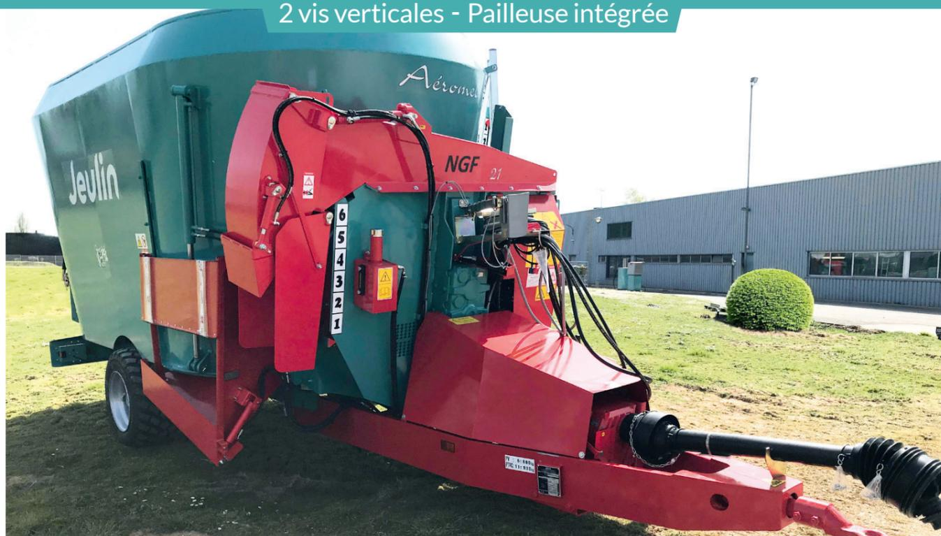
La mélangeuse pailleuse AÉROMEL dispose de deux vis verticales de mélange entre lesquelles sont encastrées les roues et d'une cuve conique en largeur. Ainsi, elle conserve un volume de caisse adapté à chaque besoin tout en étant moins haute qu'une mélangeuse classique.
