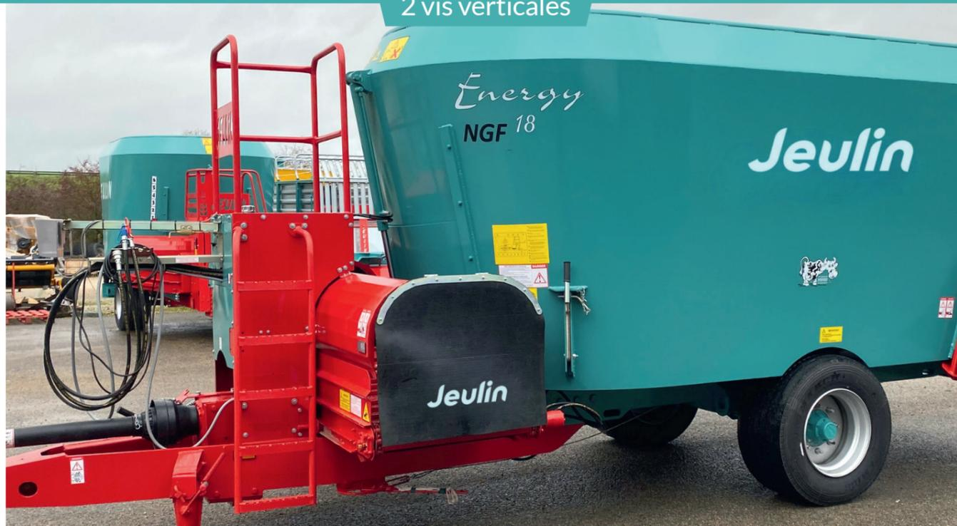
Sa singularité : une cuve abaissée grâce aux roues encastrées entre les vis de mélange afin de gagner en hauteur tout en permettant une capacité de 14 à 21m<sup>3</sup>. Robuste, polyvalente et précise, grâce à son châssis intégré 3 pesons, elle est spécialement conçue pour la fibre du fait de sa forme évasée.
